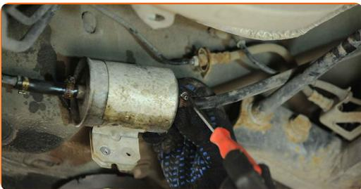
**8** Entfernen Sie den Kraftstofffilter.
