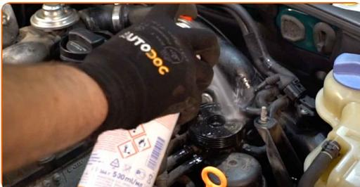
**5** Lösen Sie die Befestigung der Verbindungslinie des Kraftstofffilters.
