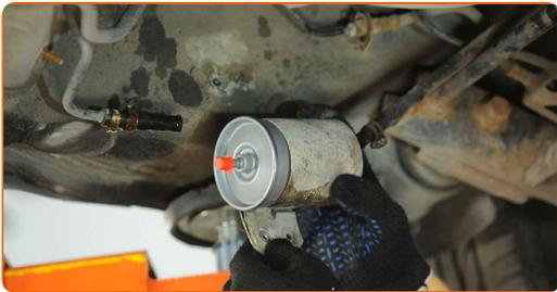
**12** Installieren Sie einen neuen Kraftstofffilter.
