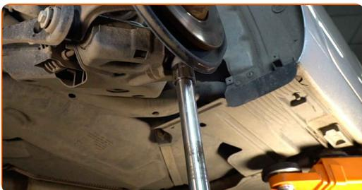
**11** Entfernen Sie die Befestigungsschraube.
