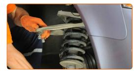
Stellen Sie das Dämpferbein auf das Federspannwerkzeug.
