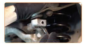
Bringen Sie die Befestigungsschraube an. Benutzen Sie einen Hammer. Verwenden Sie einen Splintentreiber.
