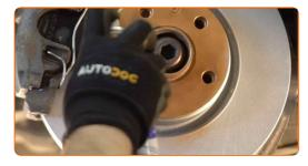
Die Bremsscheibenoberfläche reinigen. Benutzen Sie einen Bremsenreiniger.
