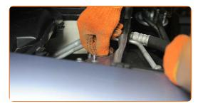
Bringen Sie die Windlaufabdeckung an, die sich an der linken Seite befindet und sichern Sie sie.
