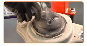
Entfernen Sie die Stangenmutter des Federkolben. Verwenden Sie Stecknuss Nr. 18. Verwenden Sie einen Ratschenschlüssel.
