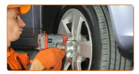
Senken Sie das Auto und ziehen Sie die Radschrauben über Kreuz an. Verwenden Sie eine Schlagnuss für Felgen 52 # 17. Verwenden Sie einen Drehmomentschlüssel. Ziehen Sie ihn mit 120 Nm Drehmoment fest.
