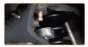
Lösen Sie den unteren Bereich des Federbeins.
