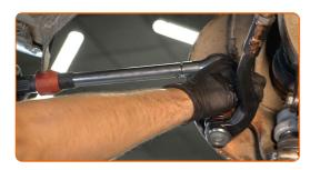
Behandeln Sie das Befestigungselement, das den Spurstangenkopf mit dem Achsschenkel verbindet. Benutzen Sie ein Kupferschmiermittel.
