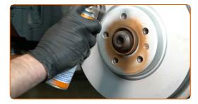
Die Bremsscheibenoberfläche reinigen. Benutzen Sie einen Bremsenreiniger.
