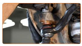
Schrauben Sie die Befestigungsmutter auf, die den Spurstangenkopf mit dem Achsschenkel verbindet. Verwenden Sie Ring-Gabelschlüssel Nr. 21.
