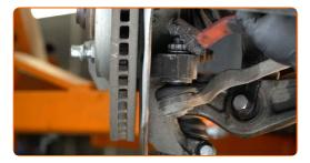
Lösen Sie das Ende der Befestigungsmutter an dem Achsschenkel. Verwenden Sie Ring-Gabelschlüssel Nr. 21.
