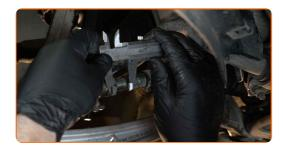
Lösen Sie die Kontermutter des Spurstangenkopf und der Zugstange. Verwenden Sie Ring-Gabelschlüssel Nr. 24 (2 Stück).
