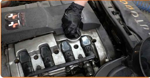
**34** Lassen Sie den Motor ein paar Minuten laufen. Nachdem die Ölstands-Warnleuchte erloschen ist, stoppen Sie den Motor.
