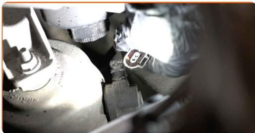
10 Schrauben Sie den Deckel der Abdeckung des Ölfilters ab.
