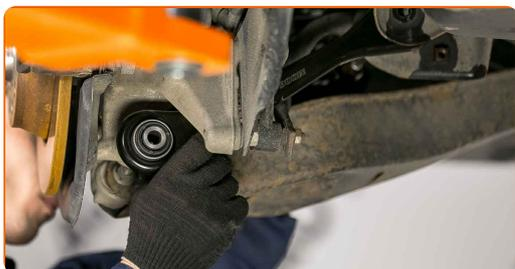
**15** Schrauben Sie das Befestigungselement ein, das den Querlenker mit dem hinteren Hilfsrahmen verbindet. Verwenden Sie Ring-Gabelschlüssel Nr. 18. Verwenden Sie Stecknuss Nr. 18. Verwenden Sie einen Ratschenschlüssel.
