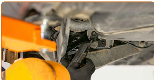
**16** Schrauben Sie die Befestigungen der Stabilisatorbuchsenhalter ein. Benutzen Sie den XZN #10. Verwenden Sie einen Drehmomentschlüssel. Ziehen Sie ihn mit 45 Nm Drehmoment fest.
