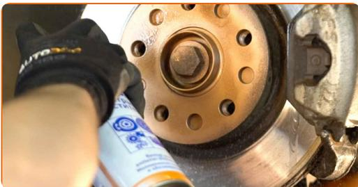
**23** Die Bremsscheibenoberfläche reinigen. Benutzen Sie einen Bremsenreiniger.
