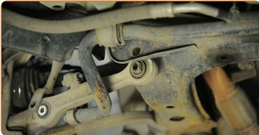
**11.2** Reinigen Sie die Befestigungselemente, die den Querlenker mit dem Hilfsrahmen verbinden. Benutzen Sie eine Drahtbürste. Benutzen Sie WD-40-Spray.
