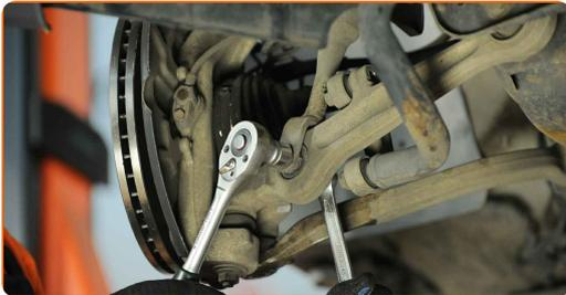
**11.1** Entfernen Sie die Befestigungsschraube.
