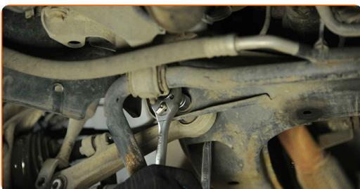
**13** Entfernen Sie die Befestigungsschraube.
