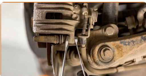
**10** Trennen Sie das Bremsseil aus dem Sattel. Verwenden Sie Schraubenzieher (2 Teile).
