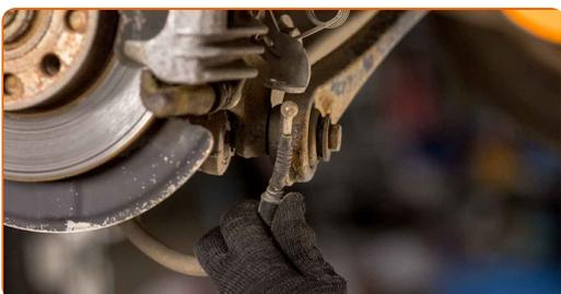
**11** Entfernen Sie den Bremssattel.
