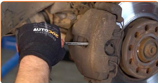
**9** Schrauben Sie die Befestigung des Bremssattels ab. Verwenden Sie Ring-Gabelschlüssel Nr. 13. Verwenden Sie Ring-Gabelschlüssel Nr. 17.
