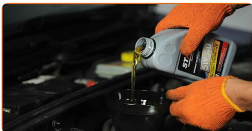
**Austausch: Motoröl und Ölfilter – Audi A4 B7 Avant. Tipp von AUTODOC-Experten:**
