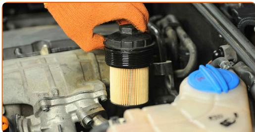
**21.2** Verwenden Sie Stecknuss Nr. 32. Verwenden Sie einen Drehmomentschlüssel. Ziehen Sie ihn mit 25 Nm Drehmoment fest.
