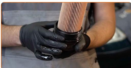
**20** Reinigen Sie die Ölfilteraufnahme.
