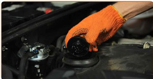
**28** Befestigen Sie den Deckel des Öleinfüllstutzens.
