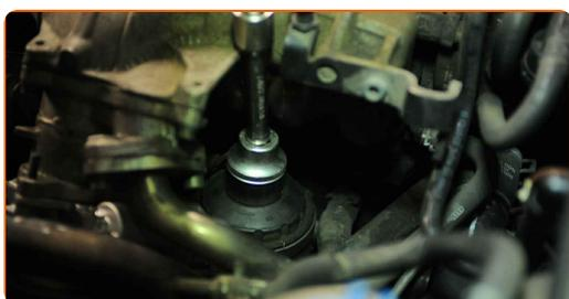
**22** Schrauben Sie die Öleinfüllschraube ab.
