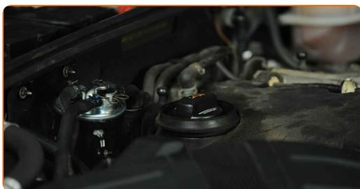
**23** Entfernen Sie die Öleinfüllschraube.
