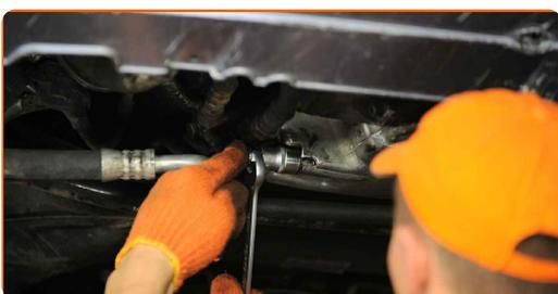
**7** Reinigen Sie den Bereich um die Ablassöffnung der Ölwanne.
