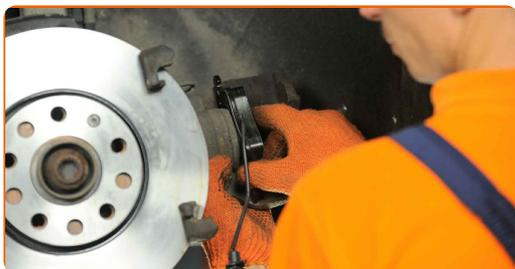
**33.1** Installieren Sie den Bremssattel und fixieren Sie diesen.
