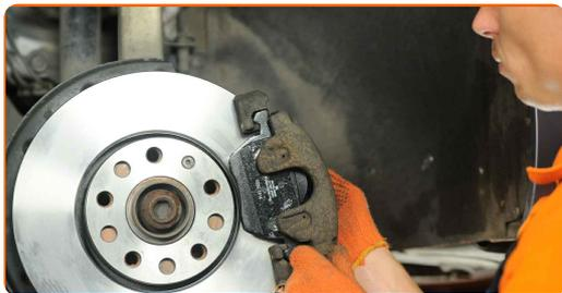
**33.2** Verwenden Sie Inbusschlüssel Nr. H7. Verwenden Sie einen Drehmomentschlüssel. Ziehen Sie ihn mit 30 Nm Drehmoment fest.
