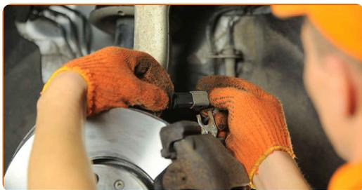
**36** Bauen Sie die Bremssattel-Haltefeder ein. Verwenden Sie einen flachen Schraubendreher.
