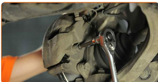
**34** Installieren Sie die Staubschutzkappen der Bremssattel-Führungsstifte.
