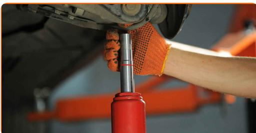
**12** Lösen Sie den unteren Teil des Stoßdämpfers. Verwenden Sie einen Splintentreiber. Benutzen Sie einen Hammer.
