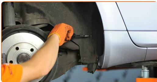
**7** Entfernen Sie die Radkastenabdeckung.
