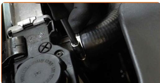
**44** Entfernen Sie den Deckel des Kühlmittelbehälters.
