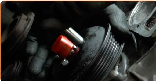
**33** Ziehen Sie die Spannrolle des Keilrippenriemens beiseite. Verwenden Sie Stecknuss Nr. 16. Verwenden Sie einen Ratschenschlüssel.
