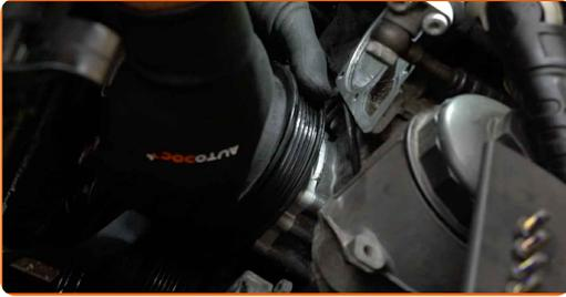
**32** Schrauben Sie die Befestigungen der Riemenscheibe der Wasserpumpe an. Verwenden Sie Stecknuss Nr. 10. Verwenden Sie einen Ratschenschlüssel.
