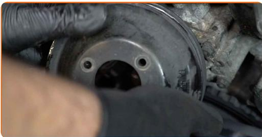
**24** Reinigen Sie die Montageposition der Wasserpumpe. Benutzen Sie eine Drahtbürste. Verwenden Sie Allzweckreinigungsspray.
