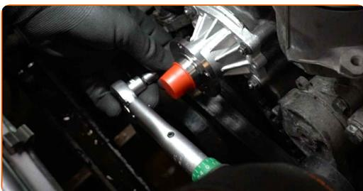
**31** Installieren Sie die Wasserpumpenriemenscheibe.
