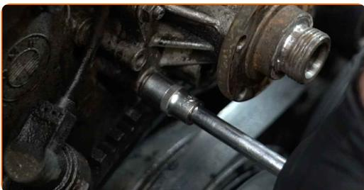
**26** Entfernen Sie die Wasserpumpe.
