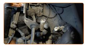
Behandeln Sie den Stecker des Bremsbelagverschleißsensors. Verwenden Sie dielektrisches Fett.
