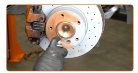
Die Bremsscheibenoberfläche reinigen. Benutzen Sie einen Bremsenreiniger.
