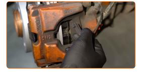
Trennen Sie den Bremsbelag Verschleißsensor.
