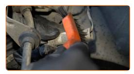
Trennen Sie den Stecker der Verschleißsensoren des Bremsbelags.
