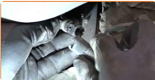
**11** Bauen Sie den Verschleißsensor auf den Bremsbelägen ein. Verwenden Sie eine Rundzange.
