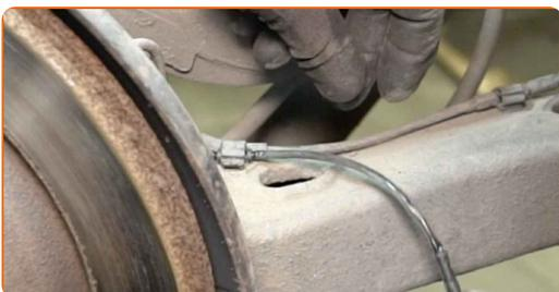
**13** Behandeln Sie den Stecker des Bremsbelagverschleißsensors. Verwenden Sie dielektrisches Fett.
