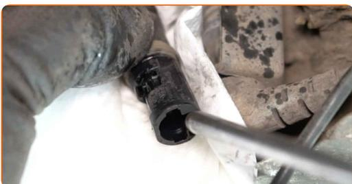
**14** Bringen Sie den Steckverbinder des Verschleißsensors der Bremsbeläge an.
