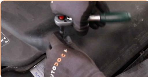
**4** Entferne die Komponenten des Lüftungskanals.
