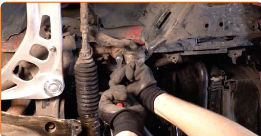
**16** Bauen Sie die untere Schallisolierung ein.
