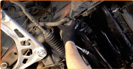
**15** Schrauben Sie die Befestigungen der Stabilisatorbuchsenhalter ein. Verwenden Sie Stecknuss Nr. 16. Verwenden Sie einen Drehmomentschlüssel. Ziehen Sie ihn mit 28 Nm Drehmoment fest.
