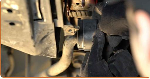
**13** Reinigen Sie die Montagesitze der Stabilisatorbuchsen. Benutzen Sie WD-40-Spray.
