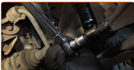
**30** Entfernen Sie den Träger unter dem Arm.
