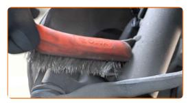
Schrauben Sie die Befestigungen ab, die das Federbein mit dem Achsschenkel verbinden. Verwenden Sie Ring-Gabelschlüssel Nr. 18. Verwenden Sie Stecknuss Nr. 18. Verwenden Sie einen Ratschenschlüssel.
