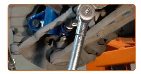
Befestigen Sie den Bremsschlauch.
