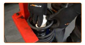
Setzen Sie das neue obere Federbeinlager ein.
