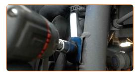
Lösen Sie den Bremsschlauch vom Federbein.
