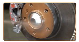
Die Bremsscheibenoberfläche reinigen. Benutzen Sie einen Bremsenreiniger.
