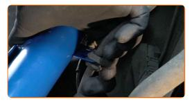
Verbinden Sie das ABS mit der Sensorverdrahtung.
