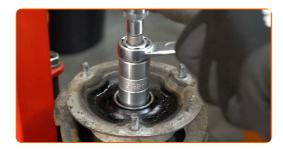
Entfernen Sie die Stoßdämpferhalterung, die Manschette und den Stoßstopp.
