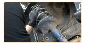
Stellen Sie das Dämpferbein auf das Federspannwerkzeug.
