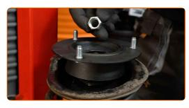
Ziehen Sie die Federbeinkolbenstangenmutter an. Verwenden Sie Stecknuss Nr. 19. Verwenden Sie Stecknuss Nr. 9. Verwenden Sie einen Drehmomentschlüssel. Ziehen Sie ihn mit 52 Nm Drehmoment fest.
