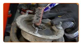
Entfernen Sie die Stangenmutter des Federkolben. Verwenden Sie Stecknuss Nr. 9. Verwenden Sie Stecknuss Nr. 22. Verwenden Sie einen Ratschenschlüssel.
