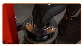
30 Dekomprimieren Sie die Feder.
