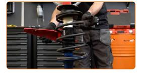
Entfernen Sie das zusammengebaute Federbein.
