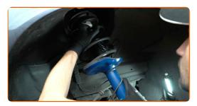
34 Sichern Sie die oberen Befestigungen des Federbeines. Schrauben Sie diese nicht fest.
