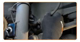
Trennen Sie die Verkabelung des ABS-Sensors.
