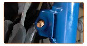
Entfernen Sie den Träger unter dem Achsschenkel.
