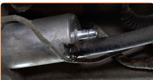
**10** Entfernen Sie den Stecker der Kraftstoffpumpe.
