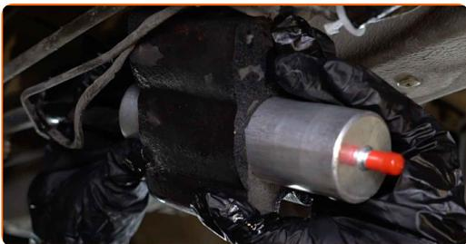
**17** Verbinden Sie die Kraftstoffleitung mit der Kraftstoffpumpe.
