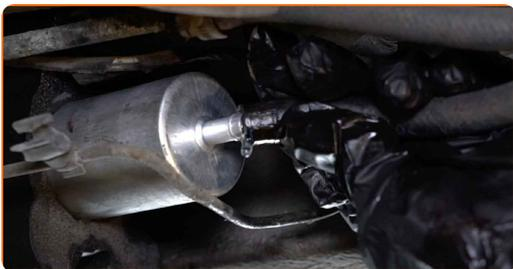
**18** Schrauben Sie die Klemmen der Kraftstoffleitungen an. Verwenden Sie Stecknuss Nr. 5. Verwenden Sie einen Ratschenschlüssel.
