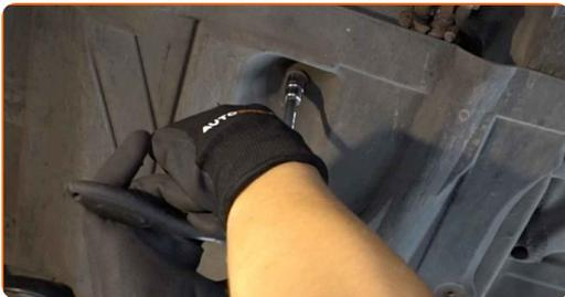
4. Entfernen Sie die Kunststoffschutzabdeckung der Karosserie.
