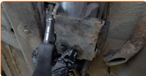
**21** Schrauben Sie die Befestigung der Halterung der Kraftstoffpumpe an. Verwenden Sie Inbusschlüssel Nr. H5. Verwenden Sie einen Ratschenschlüssel.
