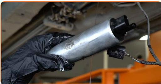
**13** Behandeln Sie den Stecker der Kraftstoffpumpe. Verwenden Sie Elektronikspray.
