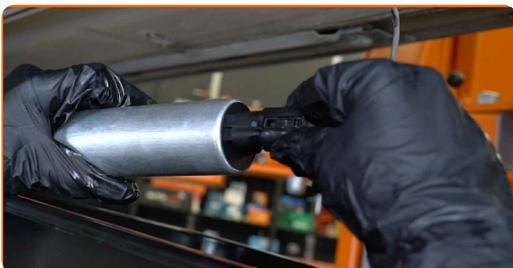
**15** Verbinden Sie die Kraftstoffleitung mit der Kraftstoffpumpe.
