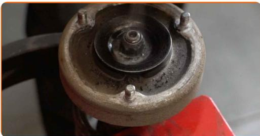
**33** Entfernen Sie die Stangenmutter des Federkolben. Verwenden Sie Inbusschlüssel Nr. H6. Verwenden Sie Stecknuss Nr. 18. Verwenden Sie einen Ratschenschlüssel.
