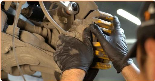
**63** Befestigen Sie die Bremssattelhalterung. Verwenden Sie Stecknuss Nr. 18. Verwenden Sie einen Drehmomentschlüssel. Ziehen Sie ihn mit 110 Nm Drehmoment fest.
