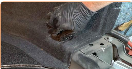
**76** Schrauben Sie die Befestigungen der Vorderseitenverkleidung des Kofferraums ein. Verwenden Sie den Torx T40. Verwenden Sie einen Ratschenschlüssel.
