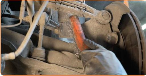
**21** Untere Befestigung der Stoßdämpferfedern abschrauben. Verwenden Sie Ring-Gabelschlüssel Nr. 18.
