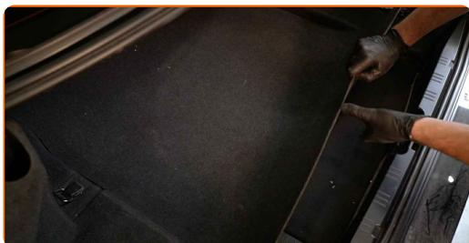
**3** Heben Sie die untere Kofferraumverkleidung an.
