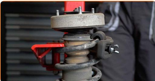
**32** Behandeln Sie die Federbeinstange. Benutzen Sie eine Drahtbürste. Benutzen Sie WD-40-Spray.
