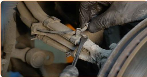
**23** Reinigen Sie alle Verbindungen des Querlenkers. Benutzen Sie eine Drahtbürste. Benutzen Sie WD-40-Spray.
