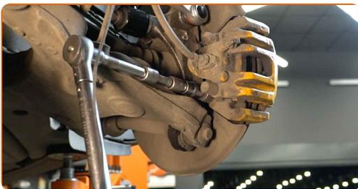
**64** Verbinden Sie den Bremsbelag-Verschleiß-Sensor.
