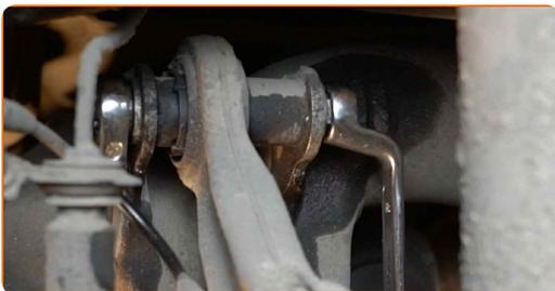
**20** Reinigen Sie die Federbein-Befestigungselemente. Benutzen Sie eine Drahtbürste. Benutzen Sie WD-40-Spray.
