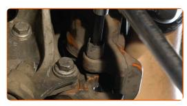
Installieren Sie die Staubschutzkappen der Bremssattel-Führungsstifte.
