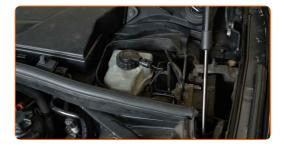
Schrauben Sie die Kappe des Bremsflüssigkeitsausgleichsbehälters ab.
