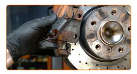
Entfernen Sie den Bremssattel.
