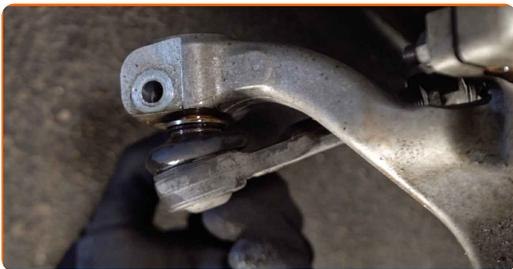
**51** Ziehen Sie die Befestigungsmutter an, die den Spurstangenkopf mit dem Achsschenkel verbindet. Verwenden Sie Stecknuss Nr. 22. Verwenden Sie einen Drehmomentschlüssel. Ziehen Sie ihn mit 80 Nm Drehmoment fest.
