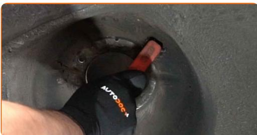
**33** Installieren Sie das Federbein am Radlauf.
