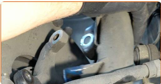
**17** Schrauben Sie das obere Befestigungselement des Federbeins ab.
