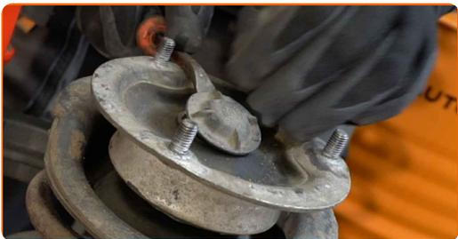
**22** Behandeln Sie die Federbeinstange. Benutzen Sie eine Drahtbürste. Benutzen Sie WD-40-Spray.
