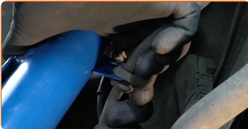
**41** Verbinden Sie das ABS mit der Sensorverdrahtung.
