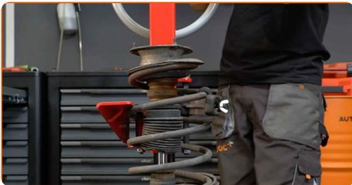
**21** Entfernen Sie die Kappe des Federbeinstützlagers. Benutzen Sie ein Brecheisen.
