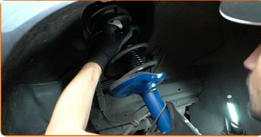
**34** Sichern Sie die oberen Befestigungen des Federbeines. Schrauben Sie diese nicht fest.
