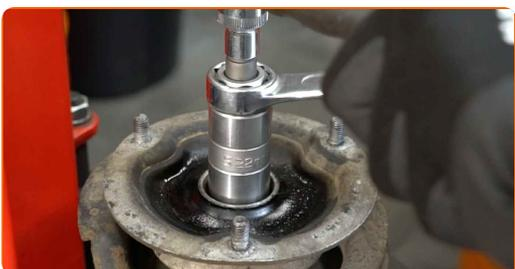
**24** Entfernen Sie die Stoßdämpferhalterung, die Manschette und den Stoßstopp.
