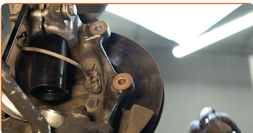
**15** Reinigen Sie die Befestigungselemente der Bremsscheibe. Benutzen Sie eine Drahtbürste. Benutzen Sie WD-40-Spray.
