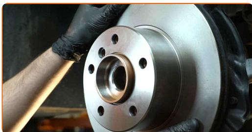
**26** Ziehen Sie die Befestigung der Bremsscheibe fest. Verwenden Sie Inbusschlüssel Nr. H6. Verwenden Sie einen Drehmomentschlüssel. Ziehen Sie ihn mit 16 Nm Drehmoment fest.
