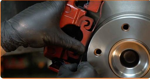
**34** Behandeln Sie die Befestigungen des Radnabenlagers. Benutzen Sie ein Kupferschmiermittel.
