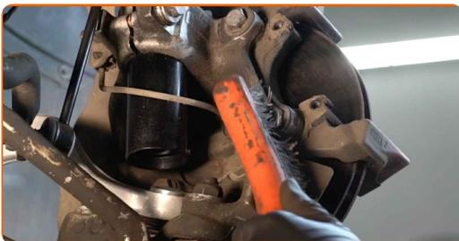
**13** Lösen Sie die Befestigung der Sattelhalterung. Verwenden Sie Stecknuss Nr. 18. Verwenden Sie ein Windeisen.
