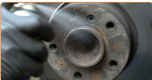
**16** Lösen Sie die Befestigung der Bremsscheibe. Verwenden Sie Inbusschlüssel Nr. H6. Verwenden Sie einen Schlagschrauber.
