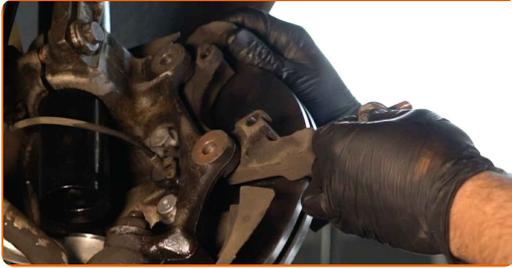
**29** Befestigen Sie die Bremssattelhalterung. Verwenden Sie Stecknuss Nr. 18. Verwenden Sie einen Drehmomentschlüssel. Ziehen Sie ihn mit 110 Nm Drehmoment fest.
