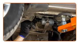
Ziehen Sie die Befestigungsmittel des Treibstofffilters fest. Verwenden Sie einen Kreuzschlitzschraubendreher.
