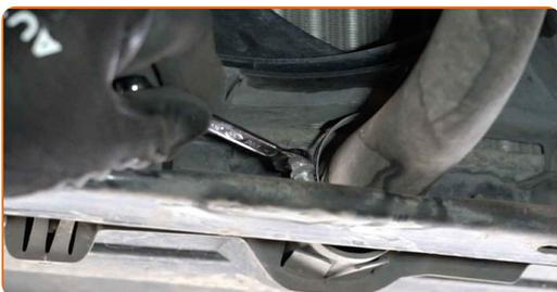
**18** Lösen Sie die untere Kühlmittleitung.
