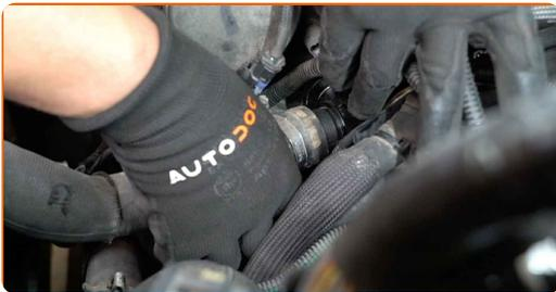
**49** Sichern Sie die Klemme des Kühlmittelschlauchs. Verwenden Sie Stecknuss Nr. 7. Verwenden Sie einen Ratschenschlüssel.
