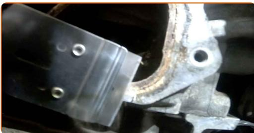
**38** Installieren Sie das neue Thermostatgehäuse.
