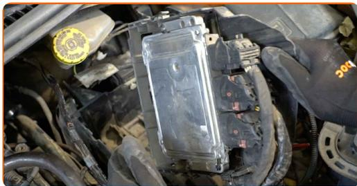
**11** Entfernen Sie die Motorkabelbaumabdeckung.
