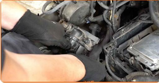
**37** Reinigen Sie den Montagesitz des Thermostatgehäuses. Verwenden Sie einen Dichtungsschaber. Verwenden Sie Allzweckreinigungsspray.
