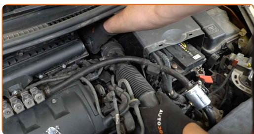
**64** Schrauben Sie das Befestigungselement des Luftansaugrohrs ein. Verwenden Sie Stecknuss Nr. 10. Verwenden Sie einen Ratschenschlüssel.
