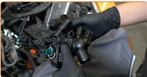
**39** Bringen Sie den Kühlmittelschlauch an.
