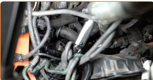
**45** Bringen Sie den Kühlmittelschlauch an.
