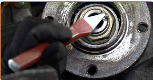
**11** Schrauben Sie die Radnaben-Achsmutter ab. Verwenden Sie Stecknuss Nr. 34. Verwenden Sie ein Windeisen.
