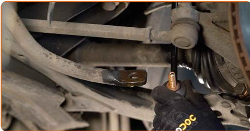
**12** Ziehen Sie das Befestigungselement an, das die Druckstange mit dem Federbein verbindet. Verwenden Sie Stecknuss Nr. 17. Verwenden Sie einen Drehmomentschlüssel. Ziehen Sie ihn mit 40 Nm Drehmoment fest.
