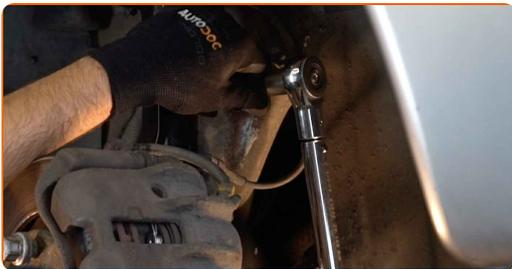
**13** Ziehen Sie das Befestigungselement an, das die Druckstange mit dem Stabilisator verbindet. Verwenden Sie Stecknuss Nr. 17. Verwenden Sie einen Drehmomentschlüssel. Ziehen Sie ihn mit 40 Nm Drehmoment fest.
