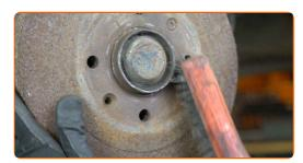
Schrauben Sie die Bremstrommelbefestigungen ab. Verwenden Sie den Torx T30. Verwenden Sie einen Schlagschrauber.
