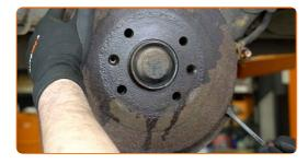
Reinigen Sie die Nabe. Benutzen Sie eine Drahtbürste.
