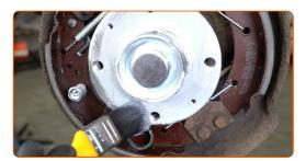
Justieren Sie den Nachsteller der Bremsbacken nach. Benutzen Sie ein Brecheisen.
