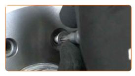
Ziehen Sie die Bremstrommelbefestigungen an. Verwenden Sie den Torx T30. Verwenden Sie einen Drehmomentschlüssel. Ziehen Sie ihn mit 10 Nm Drehmoment fest.
