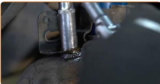
**22** Entfernen Sie die Halterung des Bremsschlauchs.
