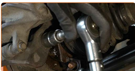
**79** Installieren Sie die Halterung des Bremsschlauchs.
