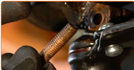
**29** Reinigen Sie das Befestigungselement, das den Spurstangenkopf mit dem Achsschenkel verbindet. Benutzen Sie eine Drahtbürste. Benutzen Sie WD-40-Spray.
