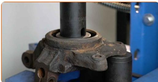
**47** Reinigen Sie den Einbauort für die Nabenlagerung. Benutzen Sie eine Drahtbürste. Benutzen Sie WD-40-Spray.
