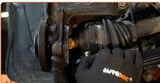
**61** Verbinden Sie das Kugelgelenk mit dem Achsschenkel.
