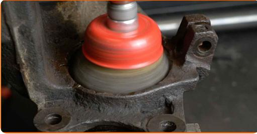
**48** Drücken Sie das neue Lager in dem Achsschenkel. Druckstücksatz, Ein-/Auspresswerkzeug.
