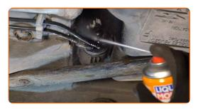
Entfernen Sie die Kraftstoffleitungen aus der Karosserie.
