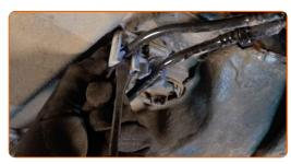
Drücken Sie die Clips zusammen und lösen Sie die Kraftstoffzufuhrleitungen vom Kraftstofffiltergehäuse. Verwenden Sie Kraftstoffleitungszangen. Benutzen Sie ein Brecheisen.
