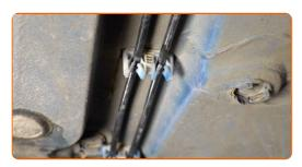
Den Flüssigkeitsbehälter unter dem Kraftstofffilter entfernen.
