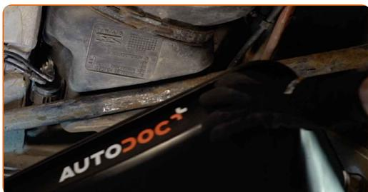
**5** Reinigen Sie die Befestigungen der Kraftstoff-Zuleitungen. Verwenden Sie Allzweckreinigungsspray.
