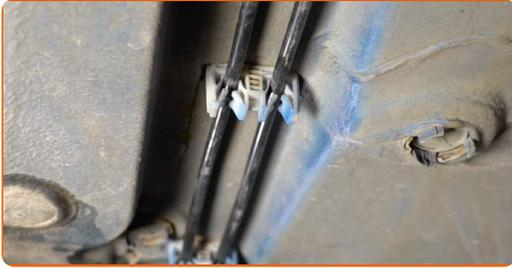
**13** Den Flüssigkeitsbehälter unter dem Kraftstofffilter entfernen.
