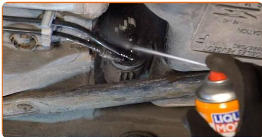
**6** Entfernen Sie die Kraftstoffleitungen aus der Karosserie.
