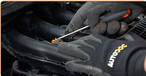
**4** Schrauben Sie die Zündspulenklammer ab. Verwenden Sie Stecknuss Nr. 8.
