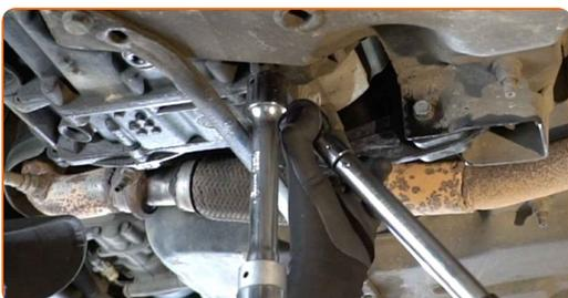
**18** Entfernen Sie die Unterstützung unter dem Getriebe.
