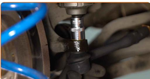
**17** Schrauben Sie die Feststellmutter des Spurstangenkopfes auf. Verwenden Sie Ring-Gabelschlüssel Nr. 22 (2 Teile).
