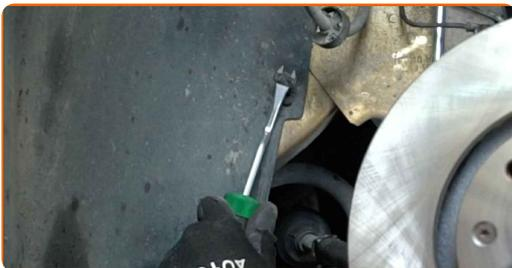
**21** Entfernen Sie die Radkastenabdeckung.
