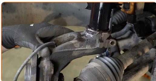
**56** Befestigen Sie das Dämpferbein auf dem Achsschenkel.
