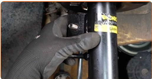
**85** Ziehen Sie das Befestigungselement an, das die Druckstange mit dem Federbein verbindet. Verwenden Sie Stecknuss Nr. 17. Verwenden Sie einen Drehmomentschlüssel. Ziehen Sie ihn mit 43 Nm Drehmoment fest.
