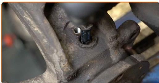
**53** Schrauben Sie die Befestigung, die den ABS-Sensor am Achsschenkel verbindet, fest. Verwenden Sie Stecknuss Nr. 13. Verwenden Sie einen Drehmomentschlüssel. Ziehen Sie ihn mit 10 Nm Drehmoment fest.
