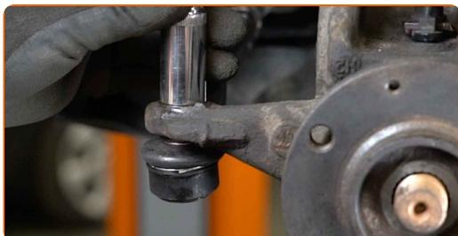
**74** Schrauben Sie die Befestigungen fest, die das Kugelgelenk mit dem Querlenker verbinden. Verwenden Sie Stecknuss Nr. 16. Verwenden Sie einen Drehmomentschlüssel. Ziehen Sie ihn mit 60 Nm Drehmoment fest.
