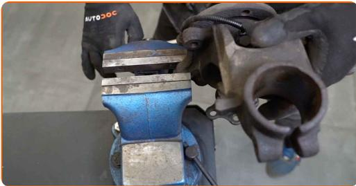
**37** Reinigen Sie den Befestigungssitz des ABS-Sensors. Benutzen Sie eine Drahtbürste. Benutzen Sie WD-40-Spray.
