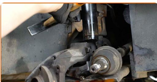
**35** Entfernen Sie die Achsschenkel zusammen mit der Nabe.
