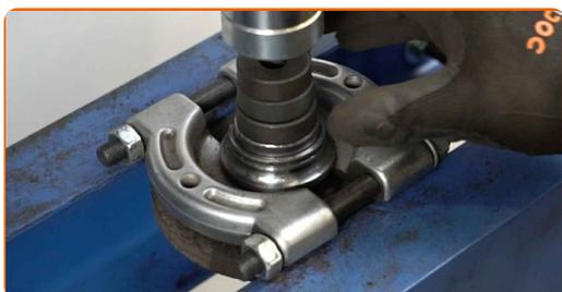
**45** Drücken Sie das Radnabenlager heraus. Verwenden Sie einen Druckstücksatz mit Ein-/Auspresswerkzeug.
