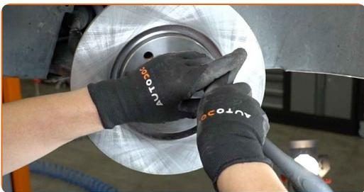
**24** Entfernen Sie die Bremsscheibe.
