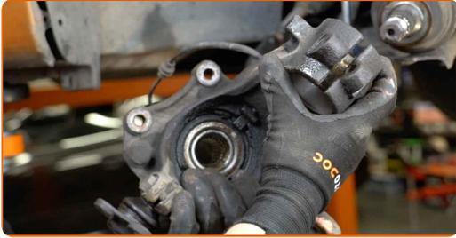
**36** Stellen Sie den mit der Radnabe zusammengebauten Achsschenkel in einen Schraubstock.
