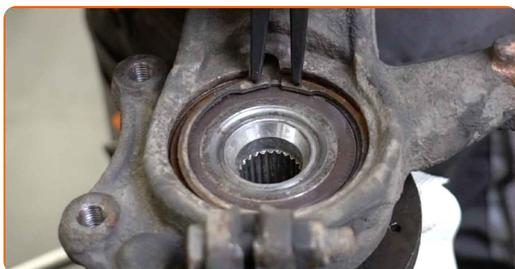
**42** Lösen Sie den Schraubstock und entfernen Sie den mit der Radnabe zusammengebauten Achsschenkel.
