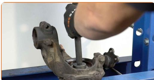
**44** Ziehen Sie den Lagerinnenring aus der Radnabe heraus. Verwenden Sie einen Druckstücksatz mit Ein-/Auspresswerkzeug. Verwenden Sie ein ein Trennmesser für Lager.
