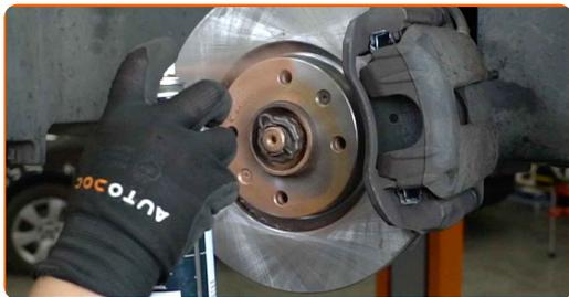
**93** Die Bremsscheibenoberfläche reinigen. Benutzen Sie einen Bremsenreiniger.
