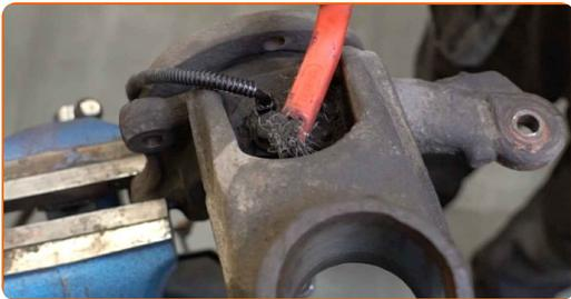
**38** Schrauben Sie die Befestigung des ABS-Sensors ab. Verwenden Sie Stecknuss Nr. 13. Verwenden Sie einen Ratschenschlüssel.
