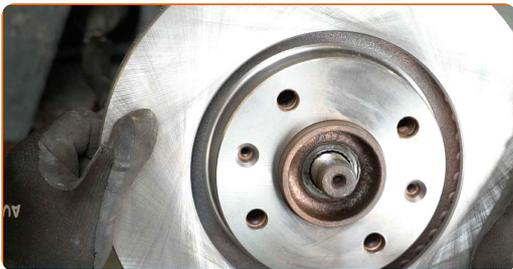
**25** Lösen Sie das Ende der Befestigungsmutter an dem Achsschenkel. Verwenden Sie Stecknuss Nr. 17. Verwenden Sie einen Ratschenschlüssel.
