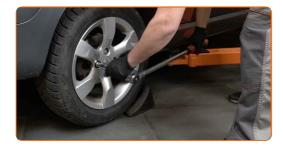
Entfernen Sie den Wagenheber sowie die Unterlegkeile.
