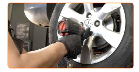
Senken Sie das Auto und ziehen Sie die Radschrauben über Kreuz an. Verwenden Sie eine Schlagnuss für Felgen # 17. Verwenden Sie einen Drehmomentschlüssel. Ziehen Sie ihn mit 100 Nm Drehmoment fest.
