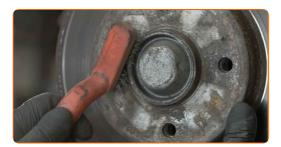
Entfernen Sie die Schutzkappe des Nabenlagers. Benutzen Sie einen Hammer. Benutzen Sie ein Brecheisen.
