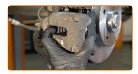
Das Kabel der Feststellbremse in die Bremssattelhalterung einbauen. Verwenden Sie eine Wasserpumpenzange. Verwenden Sie Zangen.
