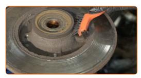
Entfernen Sie den ABS-Sensorring. Benutzen Sie ein Brecheisen.
