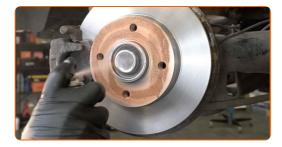
Die Bremsscheibenoberfläche reinigen. Benutzen Sie einen Bremsenreiniger.
