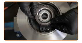
Reinigen Sie den Achsschenkel. Benutzen Sie eine Drahtbürste. Verwenden Sie Allzweckreinigungsspray.
