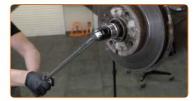
Entfernen Sie die mit der Radnabenlagerung zusammengebaute Bremsscheibe. Verwenden Sie den Schlaghammer-Nabenabzieher.
