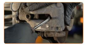
Entfernen Sie den Bremssattel.
