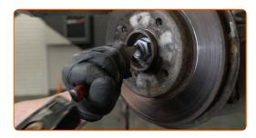
Reinigen Sie das Befestigungselement der Radnabe. Benutzen Sie WD-40-Spray.
