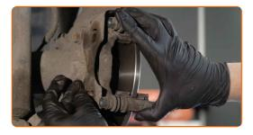
Befestigen Sie die Bremssattelhalterung. Verwenden Sie den Torx T50. Verwenden Sie einen Drehmomentschlüssel. Ziehen Sie ihn mit 53 Nm Drehmoment fest.
