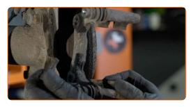
Reinigen Sie die Schutzkappe des Nabenlagers. Benutzen Sie eine Drahtbürste. Benutzen Sie WD-40-Spray.
