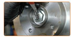
Installieren Sie die Schutzkappe des Nabenlagers. Verwenden Sie einen Gummi-Hammer.
