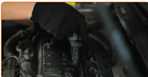
**15** Schrauben Sie die Schrauben der Zündspule fest. Verwenden Sie Stecknuss Nr. 8. Verwenden Sie einen Drehmomentschlüssel. Ziehen Sie ihn mit 10 Nm Drehmoment fest.
