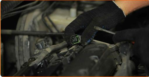
**6** Schrauben Sie die Schrauben der Zündspule ab. Verwenden Sie Stecknuss Nr. 8. Verwenden Sie einen Ratschenschlüssel.
