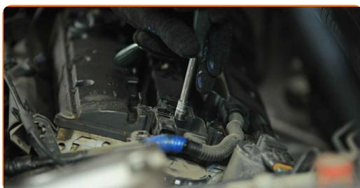
**16** Schließen Sie den Anschluss der Zündspule an.
