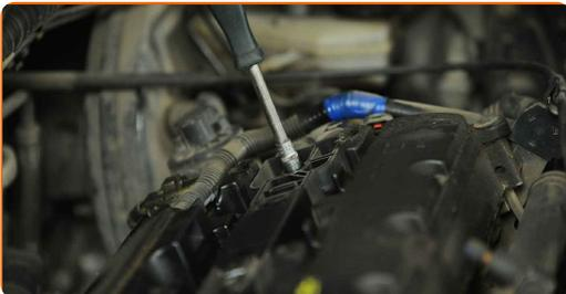
**7** Entfernen Sie die Zündspule, indem Sie sie direkt nach oben herausziehen.
