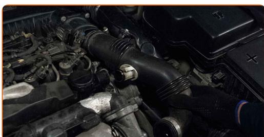
**7** Decken Sie das Turboladerlaufrad mit einem Mikrofaser Tuch ab, damit keine Verschmutzungen und Fremdkörper in das System gelangen.
