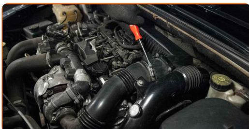
**6** Entferne die Komponenten des Lüftungskanal. Verwenden Sie einen flachen Schraubendreher.
