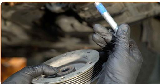
**99** Schrauben Sie die Befestigung der Kurbelwellenriemenscheibe fest. Verwenden Sie Stecknuss Nr. 22. Verwenden Sie einen Drehmomentschlüssel. Ziehen Sie ihn mit 80 Nm Drehmoment fest.+60°
