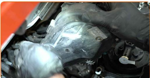
**33** Ziehen Sie die Spannrolle des Keilrippenriemens beiseite. Verwenden Sie Ring-Gabelschlüssel Nr. 15.
