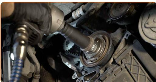
**89** Entfernen Sie die Befestigungsschraube.
