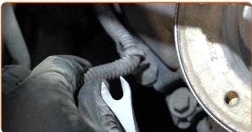
**31** Schrauben Sie die Befestigungen der oberen Zahnriemenabdeckung ab. Verwenden Sie Ring-Gabelschlüssel Nr. 10.
