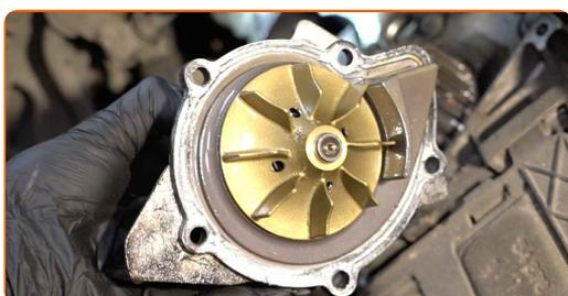
Austausch: Zahnriemensatz mit Wasserpumpe – CITROËN C8 (EA\_, EB\_).
