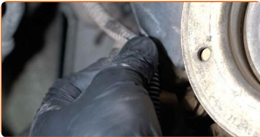
**104** Ziehen Sie die Spannrolle des Keilrippenriemens beiseite. Verwenden Sie Ring-Gabelschlüssel Nr. 15.
