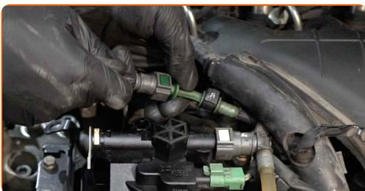
**118** Drücken Sie die Kraftstoff-Entlüftungspumpe mehrere Male, bis diese hart wird.
