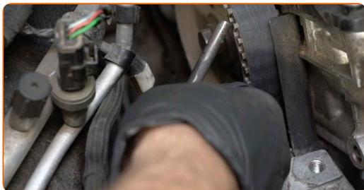
**86** Schrauben Sie die Befestigung der Kurbelwellenriemenscheibe ein. Verwenden Sie Stecknuss Nr. 22. Verwenden Sie einen Ratschenschlüssel.
