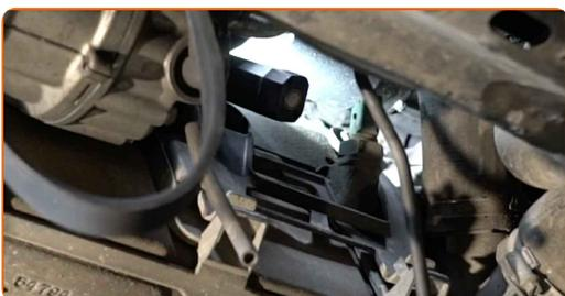
**101** Behandeln Sie den Steckverbinder des Kurbelwellensensors. Verwenden Sie Allzweckreinigungsspray.
