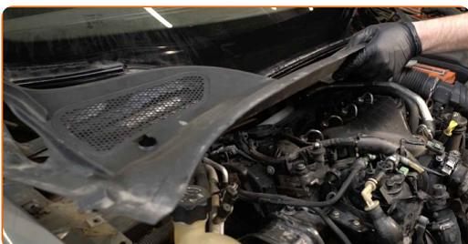
**120** Bringen Sie die Befestigungselemente der Windlaufabdeckung an.
