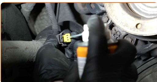
**102** Verbinden Sie den Steckverbinder des Kurbelwellensensors.
