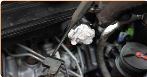
**14** Schrauben Sie die Glühkerzen aus. Verwenden Sie die Zündkerzennuss # 12. Verwenden Sie einen Drehmomentschlüssel.
