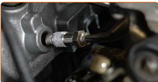
**18** Schrauben Sie die Glühkerzen fest. Verwenden Sie die Zündkerzennuss # 12. Verwenden Sie einen Drehmomentschlüssel. Ziehen Sie ihn mit 25 Nm Drehmoment fest.
