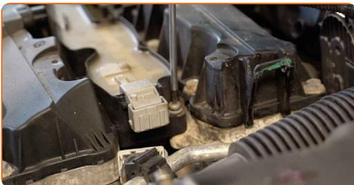
**8** Heben Sie die Zündspule an. Benutzen Sie ein Brecheisen.
