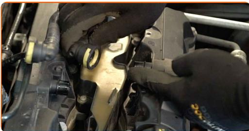
**6** Ziehen Sie den Anschluss der Zündspule ab.
