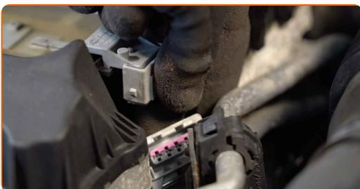
**7** Schrauben Sie die Zündspulenklammer ab. Verwenden Sie den Torx T27.
