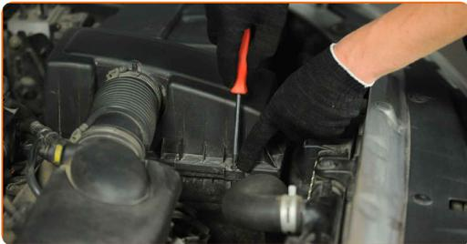
**4** Entfernen Sie die Abdeckung des Luftfilters.
