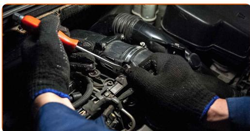
**9** Lösen Sie die Befestigungsschrauben der Luftfilter-Abdeckung. Verwenden Sie einen Kreuzschlitzschraubendreher.
