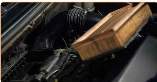
**12** Reinigen Sie die Abdeckung und das Gehäuse des Luftfilters.
