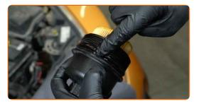
Befestigen Sie die Abbdeckung des Ölfiltergehäuses. Verwenden Sie Stecknuss Nr. 27. Verwenden Sie einen Drehmomentschlüssel. Ziehen Sie ihn mit 25 Nm Drehmoment fest.
