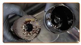
Den Dichtungsring des Ölfilterdeckels entfernen. Verwenden Sie einen flachen Schraubendreher.
