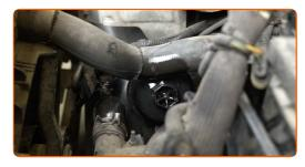
Schrauben Sie den Filtergehäusedeckel zusammen mit dem alten Filterelement ab. Verwenden Sie Stecknuss Nr. 27. Verwenden Sie einen Ratschenschlüssel.
