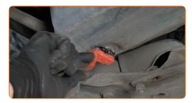
Drehen Sie die Ablassschraube heraus. Verwenden Sie Inbusschlüssel Nr. H6. Verwenden Sie einen Ratschenschlüssel.
