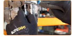
Entfernen Sie die Haltefeder des Bremsbelags. Verwenden Sie eine Rundzange.
