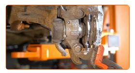
Entfernen Sie die Halteklammer der Bremsbeläge. Benutzen Sie ein Brecheisen. Verwenden Sie einen Gummi-Hammer.
