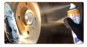
Die Bremsscheibenoberfläche reinigen. Benutzen Sie einen Bremsenreiniger.
