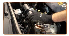
Entfernen Sie Schmutz, Staub und Ablagerungen von den Zündkerzenbohrung.
