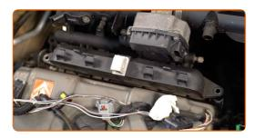
Ziehen Sie die Zündspulen Befestigung an. Verwenden Sie Stecknuss Nr. 10. Verwenden Sie einen Drehmomentschlüssel. Ziehen Sie ihn mit 9 Nm Drehmoment fest.
