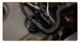
5 Entfernen Sie die Kurbelgehäuse-Entlüftungsschläuche.
