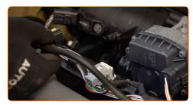
Trennen Sie den Kurbelgehäuse-Entlüftungsschlauch vom Ansaugkrümmer.
