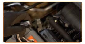
Decken Sie das PCV-Ventilloch mit einem Mikrofasertuch ab, um zu verhindern, dass Schmutz und Fremdkörper in das System gelangen.
