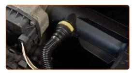
Montieren Sie die Kurbelgehäuse-Entlüftungsschläuche.
