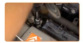
Heben Sie die Zündspule an. Entnehmen Sie die Zündspule aus der Vertiefung für die Zündkerze.
