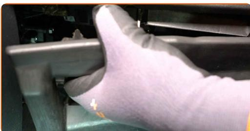
**3** Entfernen Sie die Abdeckung des Innenraumfiltergehäuses.
