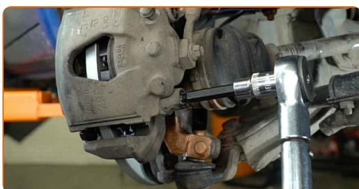
**31** Installieren Sie die Staubschutzkappen der Bremssattel-Führungsstifte.
