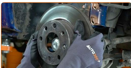
**Austausch: Bremsscheiben – Opel Corsa S93. Tipp von AUTODOC:**
