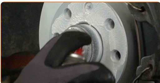
**35** Die Bremsscheibenoberfläche reinigen. Benutzen Sie einen Bremsenreiniger.
