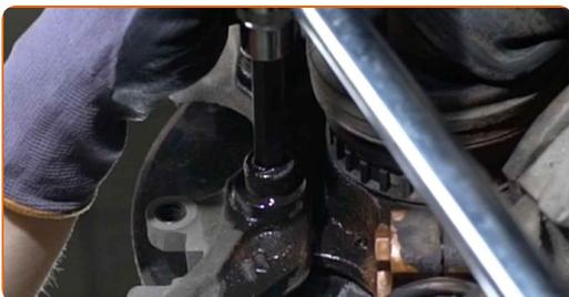
**16** Entfernen Sie die Sattelhalterung.
