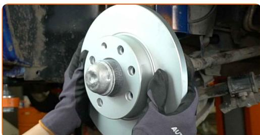
**21** Schrauben Sie die Bremsscheibenbefestigung ein. Verwenden Sie einen Kreuzschlitzschraubendreher.
