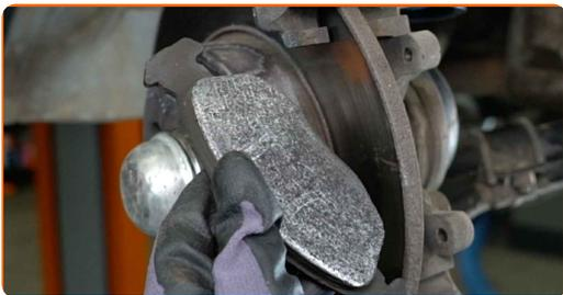
**14** Die Befestigungselemente der Bremssattelhalterung reinigen. Benutzen Sie eine Drahtbürste. Benutzen Sie WD-40-Spray.
