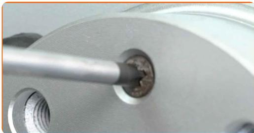
**22** Ziehen Sie die Befestigung der Bremsscheibe fest. Verwenden Sie einen Kreuzschlitzschraubendreher. Verwenden Sie einen Drehmomentschlüssel. Ziehen Sie ihn mit 7 Nm Drehmoment fest.
