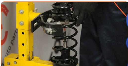
**28** Installieren Sie die Manschette und eine Stoßstopp auf den Stoßdämpfer.
