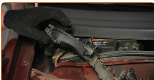
**16** Reinigen Sie die Befestigungselemente der oberen Federbeinhalterung. Benutzen Sie eine Drahtbürste. Benutzen Sie Sie WD-40-Spray.
