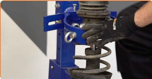
**Austausch: Federn – Opel Corsa S93. Tipp von AUTODOC:**
