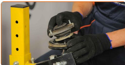
**31** Ziehen Sie die Federbeinkolbenstangenmutter an. Verwenden Sie Stecknuss Nr. 19. Verwenden Sie einen Drehmomentschlüssel. Ziehen Sie ihn mit 55 Nm Drehmoment fest.
