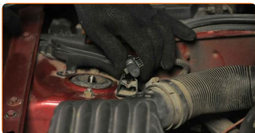
**14** Schrauben Sie die Befestigungen der Halterung des Motorkabelbaums ab. Verwenden Sie Stecknuss Nr. 10. Verwenden Sie einen Ratschenschlüssel.
