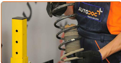
**26** Die Staubkappe des Stoßdämpfers und den Anschlagpuffer entfernen.
